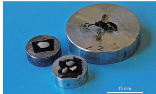
図2 走査電子顕微鏡で観察する試料
